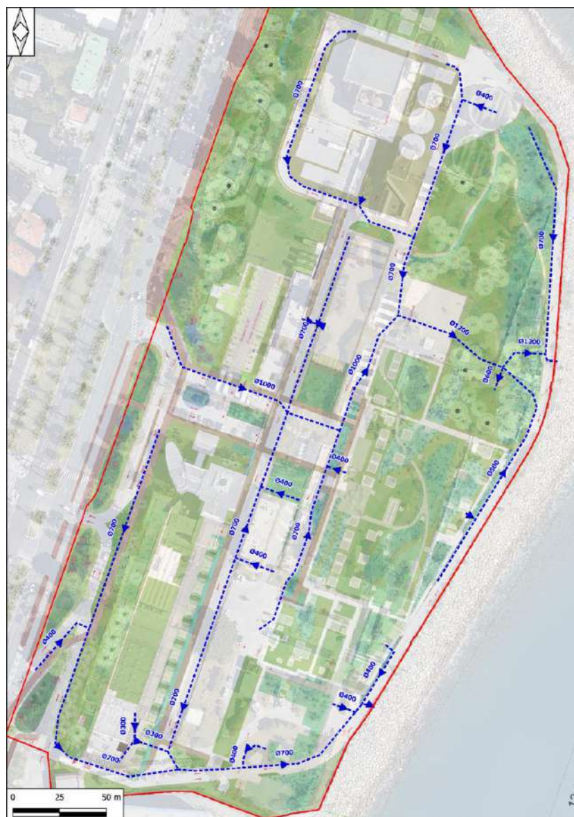
Figure 135 : Réseau d'eaux pluviales mis en place dans le cadre du projet
