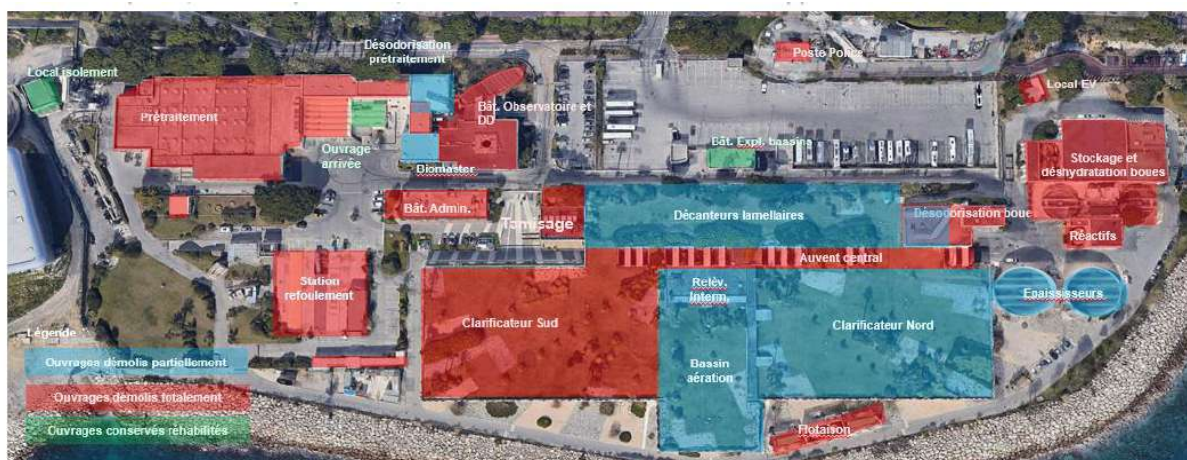
Figure n°23. LOCALISATION DES OUVRAGES QUI SERONT DEMOLIS (EN ROUGE), PARTIELLEMENT DEMOLIS (EN BLEU) ET CONSERVES (EN VERT)
